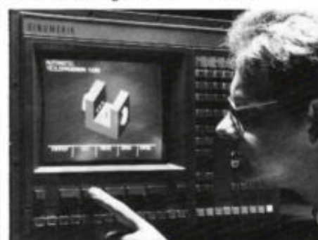
Afb. 5. Bedieningspaneel van een Sinumerik contourbesturing uit de 850/880 serie.
