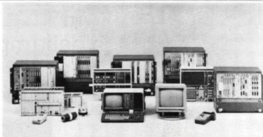
Afb. 9. De Sirotec RCM familie. RCM betekent Robot Control Multiprocessor wat al aangeeft dat er voor de besturing van de coördinaataandrijvingen individuele micro's worden gebruikt.
