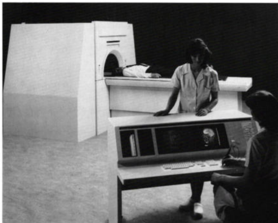
Afb. 7. Een installatie voor NMR-tomografie (Gyrosan). De eigenlijke aftaster bevindt zich op de achtergrond.
