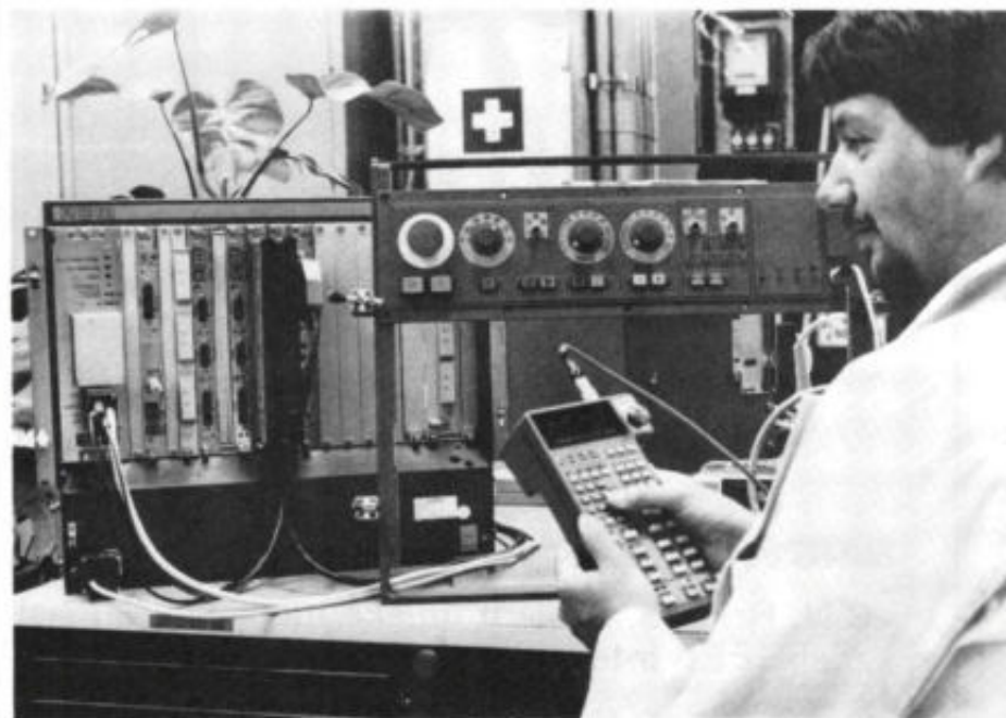
Afb. 11. Voor snelle montagerobots kan meestal worden volstaan met vrij simpele besturingen. Hier een RCM 1 voor dit doel, waarbij duidelijk de teach-in pendant te zien is.
