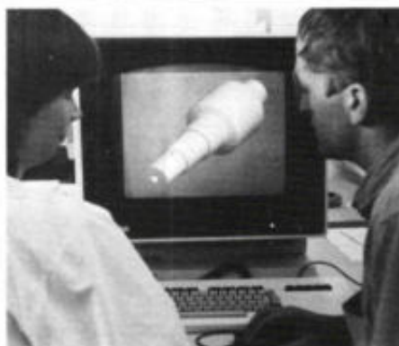
Afb. 12. Bij het computerondersteund ontwerpen nemen de Apollo Domain-werkstations een dominerende plaats in. Hier zo'n station, voorzien van een 32-bit processor als onderdeel van het Sicomp CAD-systeem.
