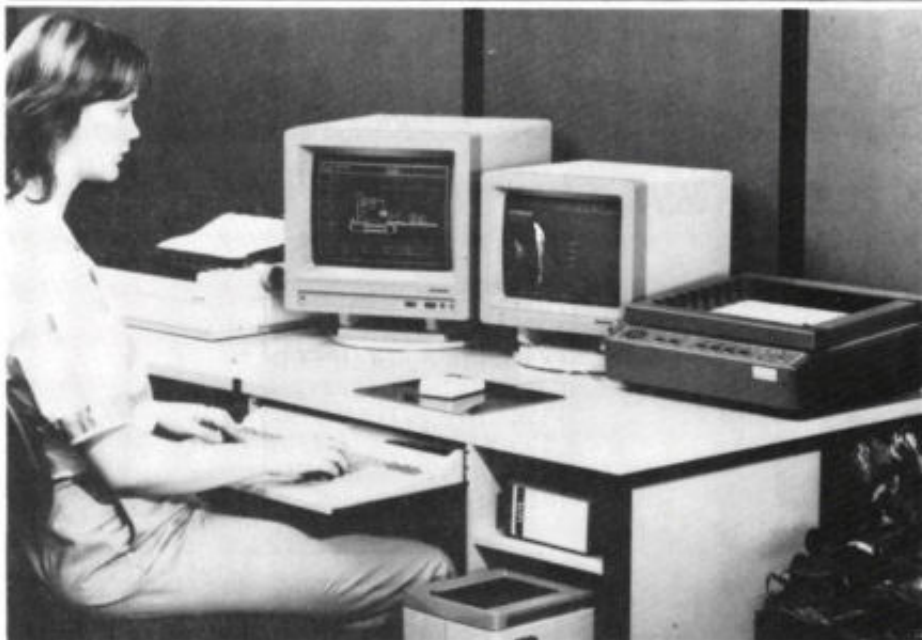
Afb. 6. Een overzichtsfoto van een configuratie van een werkstation voor numerieke besturingen, dat is opgebouwd rond de personal computer PC 16-11.
